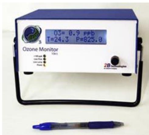
Modle 106-L, 106-M 和 106-H 臭氧检测仪, 这里 L、M 和 H 分别代表低 (0-100ppm)、中 (0-1000ppm) 和高 (0-20wt%) 三种臭氧浓度。仪器有不同的光路长度, 以适用于大量程臭氧浓度检测, 覆盖多达 8 个数量级。此外 Model 106-H 设计流量通道可承受高达 50psi 压力, 与臭氧发生器共同工作进行在线测量。三种型号 L、M 和 H 均有标准台式或壁挂式机壳。
